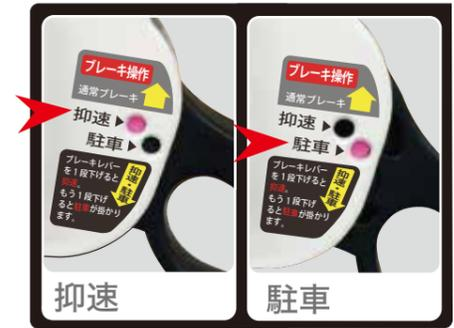
手元で簡単に抑速機能のオン・オフができます。(抑速表示の丸窓が赤色の時は抑速オン)です。ブレーキレバーを一番下まで押し下げると駐車ブレーキが掛かります。
