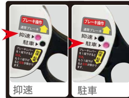
手元で簡単に抑速機能のオン・オフができます。(抑速表示の丸窓が赤色の時は抑速オン)です。ブレーキレバーを一番下まで押し下げると駐車ブレーキが掛かります。
