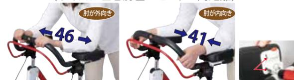
フィットし易い様に肘置の角度を調節できます。肘を内向きにさせたい時は、肘置の裏側に付いている2箇所のビスを緩めて調節します。(写真右)
