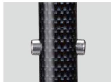
先ゴムが片減りした時は前後の支柱の向きを変えます。脚部パイプの両サイドに固定ピンが付いているので、脚部パイプを反転させれば完了です。先ゴムの4点使用ができて長持ち。
